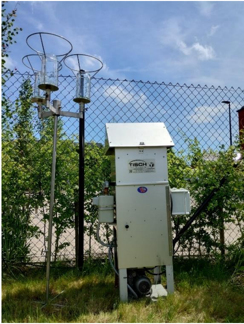
Figuur 6: Foto van de meetopstelling voor actieve bemonstering van de omgevingslucht en stofdepositie.
