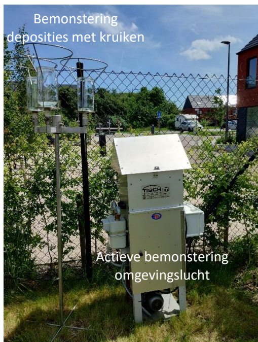
Figuur 1: Foto van de fijnstofbemonsteraar (Tisch, onderaan op foto). Omgevingslucht wordt via de bemonsteringskop bovenaan aangezogen, door een filter en PUF. De bemonstering van deposities wordt uitgevoerd met kruiken (links op foto).
