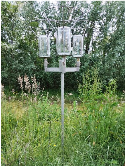
Figuur 3: Opstelling met drie Bergerhoff-neerslagkruiken in een houder met vogelscherm op paal.
